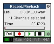
Im Modus Stop und Playback lässt sich durch Drehen des Encoders 2 die Wiedergabeposition verändern.
