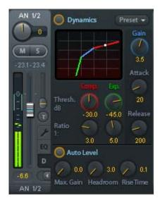
**Release.** Abfallzeit der Regelspannung für Compressor und Expander. Legt die Reaktionsgeschwindigkeit auf abfallenden Pegel fest. Einstellbar von 100 ms bis 999 ms.
