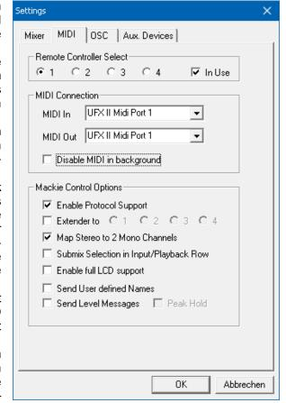
Send Level Messages. Aktiviert die Übertragung der Level Meter Daten. Peak Hold aktiviert die Peak Hold Funktion wie sie in den Preferences für die TotalMix Level Meter eingestellt wurde.
