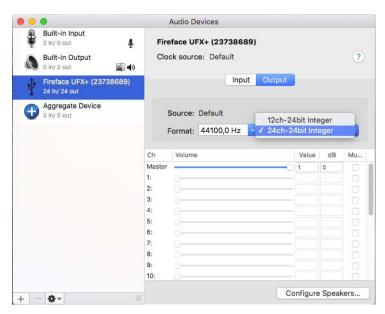
Mac OS X unterstützt USB Audio 2.0, sogar mit mehr als 2 Kanälen. Das UFX II bietet 24 Eingangs- und 24 Ausgangskanäle bei bis zu 96 kHz. Es wird als "Fireface UFX II (xxxxxxxx)" im Audio MIDI Setup gezeigt, sowohl im normalen als auch im CC-Modus. Im CC-Modus verschwindet der USB Settingsdialog, und Total-Mix zeigt – wenn überhaupt – ein 'disconnected' UFX II.
