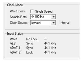
Damit wird eine Konfiguration der jeweiligen Software zur Durchführung einer digitalen Aufnahme zum Kinderspiel. Nach der Wahl des richtigen Eingangs das Fireface die aktuelle Samplefrequenz. Diese ist dann im Eigenschaftendialog des jeweiligen Aufnahme-Programms bzw. direkt im Settingsdialog einzustellen.
