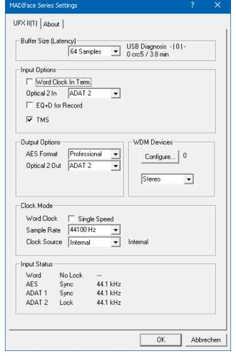
weiter temporär änderbar. Da bei einem Neustart des Rechners immer die Einstellungen aus der Registry geladen werden kann so auf einfache Weise ein definierter Ausgangszustand des Fireface UFX II erzeugt werden.
