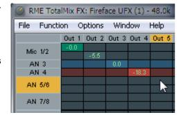
Damit die Übersicht bei verkleinertem Fenster nicht verloren geht, sind die Beschriftungen schwebend umgesetzt, verschwinden also beim Scrollen nicht aus dem Fenster.
