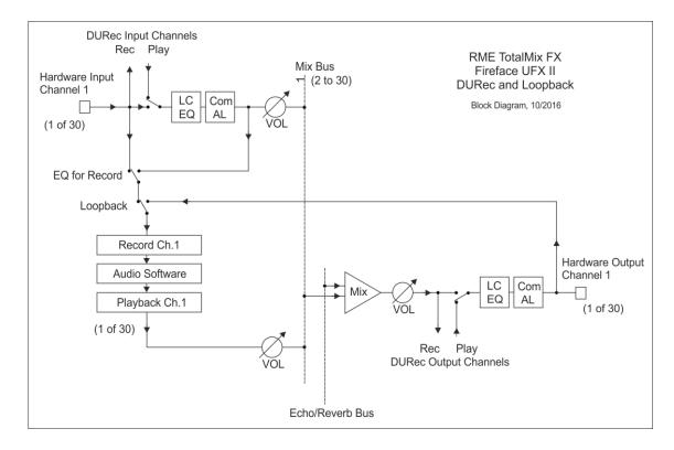
Das Blockschaltbild zeigt den Signalfluss für verschiedene Situationen, abhängig von den Schalterstellungen *Loopback*, *EQ for Record* und *Play aktiv*. Loopback und EQ for Record sind im Diagramm nicht aktiv, im Eingang erfolgt jedoch gerade eine Wiedergabe.
