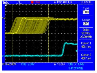
Der Screenshot zeigt ein mit circa 50 ns extrem verjittertes SPDIF-Signal (obere Linie, gelb). Dank SteadyClock wird daraus eine Clock mit weniger als 2 ns Jitter (untere Linie, Blau). Das von SteadyClock prozessierte Signal wird natürlich nicht nur intern benutzt, sondern dient auch zur Taktung der digitalen Ausgänge. Daher kann das gesäuberte und von Jitter befreite Signal bedenkenlos als Referenz-Clock benutzt werden.
