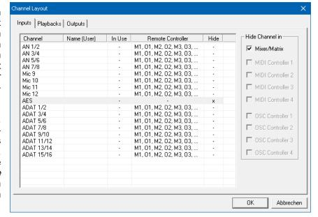
Im obigen Beispiel wurde der AES Input unsichtbar gemacht. Ist AES nicht in Benutzung kann man ihn so sehr einfach ganz aus TotalMix entfernen. Komplexere Setups zeigen z.B. ausschließlich die Kanäle der Drum-Sektion, der Bläser, oder der Streicher.
