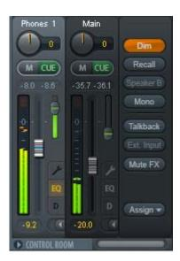
Mono. Mischt linken und rechten Kanal. Dient zur Prüfung der Mono-Kompatibilität.
