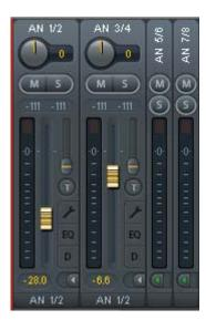
Mit dem **Pfeilsymbol** lässt sich ein Kanal horizontal verkleinern, so dass nur noch die Level Meter zu sehen sind. Ein Mausklick bei gedrückter Strg-Taste führt zum Ein- und Ausklappen aller weiter rechts befindlichen Kanäle.
