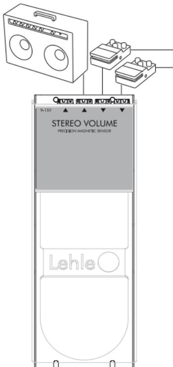
Mit diesem Setup können Sie zwei unterschiedliche Signale oder ein Stereosignal summieren, die Lautstärke regeln und mono auf einen Verstärker leiten.
